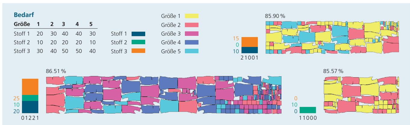
1) Lösung durch Berechnung der Materialkosten, Materialausnutzung 86,33%, Rechenzeit: 20 Minuten
